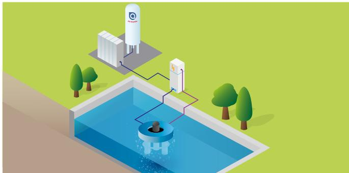
Wie der OXY INJECTOR-VENTOXAL verfügt die OXY INJECTOR-TURBOXAL-Technologie über eine elektrische Steuerung und eine vollautomatische Sauerstoff-Dosierung. Die Steuerung kann als Stand-alone-Lösung konfiguriert oder in das Prozesssteuersystem des Kunden integriert werden. Alle aufgezeichneten Messwerte wie Stromverbrauch oder Sauerstoff-Menge werden per Bildschirm im Schaltschrank angezeigt und können mit üblichen Datenübertragungssystemen an die Leitwarte des Betreibers übermittelt werden.
