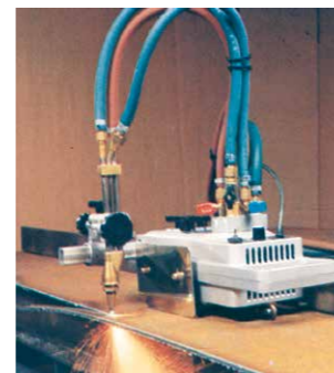
7. proFIT mit Kreisschneideinrichtung für automatische Kreisschnitte
