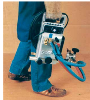
2. proFIT für automatische Geradschnitte durch Winkelprofilführung
