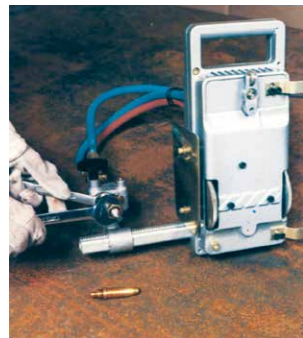
1. proFIT für beliebige Konturenschnitte durch Handführung
